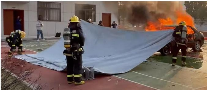
**2.4** Stellen Sie sicher, dass die Löschdecke bis zum Boden straff sitzt und dass keine Öffnungen vorhanden sind. Wenn die Löschdecke nicht das gesamte Auto bedeckt, kann das Feuer möglicherweise nicht gelöscht werden.
